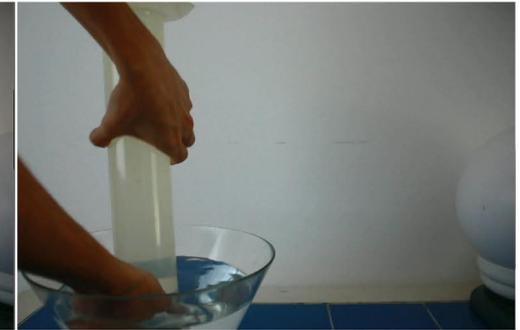
On explique la méthode pour enlever précisément 1 litre d'air à l'aide d'une éprouvette graduée.
